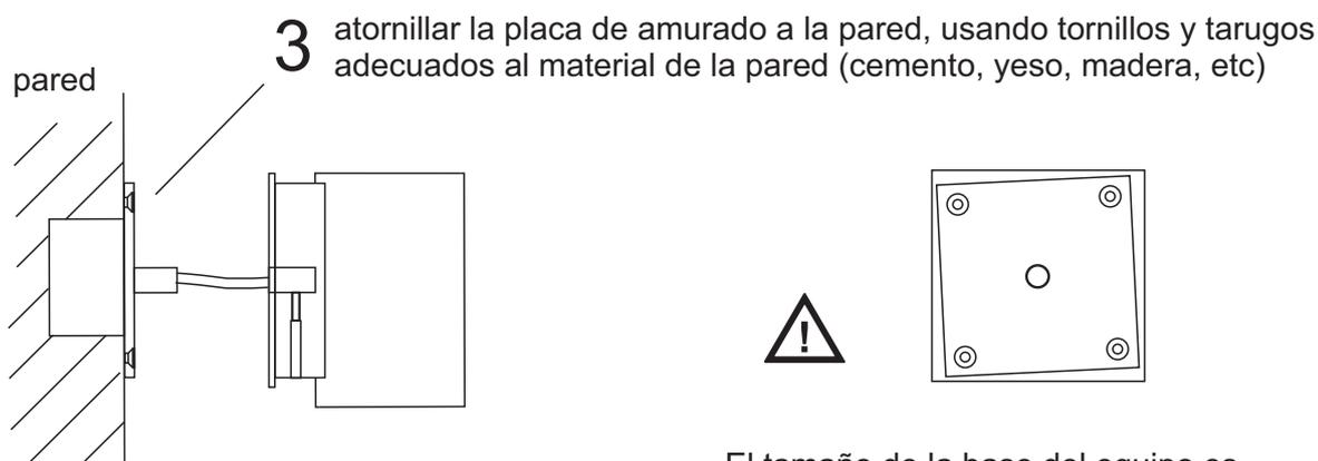
**3** atornillar la placa de amurado a la pared, usando tornillos y tarugos adecuados al material de la pared (cemento, yeso, madera, etc)
