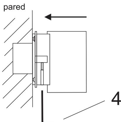
**4** insertar el cuerpo principal de la lámpara en el perno de la placa de amurado. Ajustar el tornillo inferior con la llave allen
