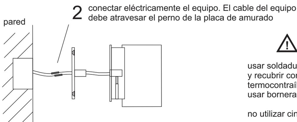
**2** conectar eléctricamente el equipo. El cable del equipo debe atravesar el perno de la placa de amurado
