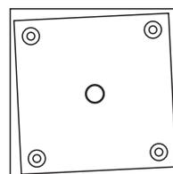
El tamaño de la base del equipo es levemente mayor al de la placa de amurado. De este modo, si la placa de amurado no ha quedado perfectamente nivelada al momento de fijarse, esto puede corregirse nivelando la base del equipo y fijándola en el ángulo adecuado.
