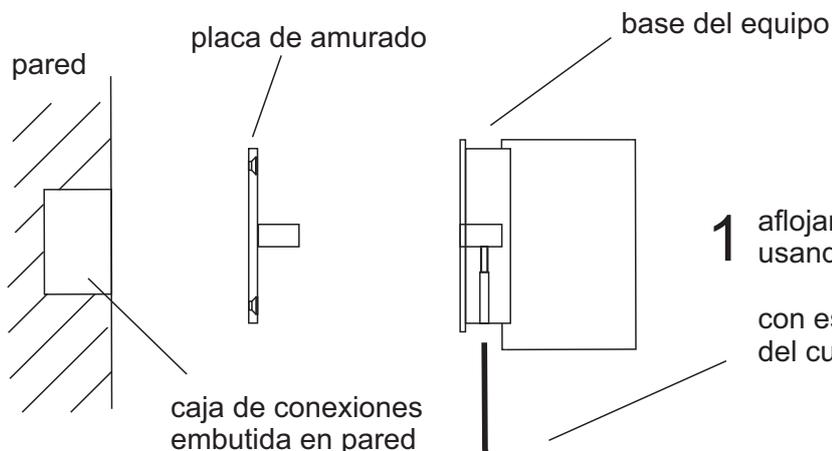
**1** aflojar el tornillo inferior de la base, usando una llave allen (se provee).
